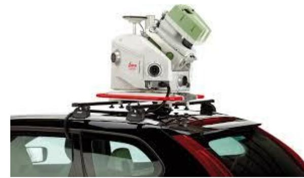
Le mobile mapping, aussi appelé cartographie mobile ou scanner dynamique, est un processus de collecte de données 3D à grande échelle à partir d'un véhicule en mouvement. Puissant et rapide, ce type de système permet également d'associer à un scanner embarqué sur un véhicule des caméras permettant de disposer d'images à 360°.
